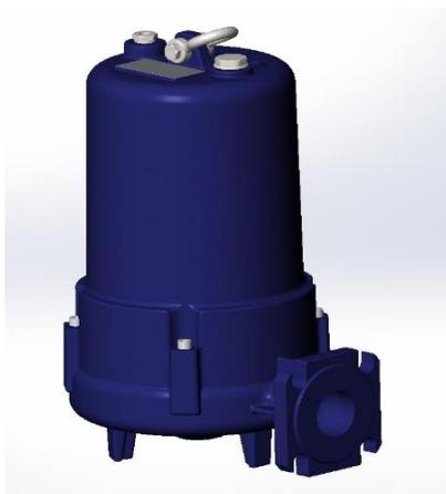
Насосы серии BIOM являются одноступенчатыми, однопоточными, несамовсасывающими, вертикальными агрегатами погружного типа с радиально расположенным напорным патрубком. Данные насосы применяются для перекачивания загрязненных вод с длинноволокнистыми примесями и твердыми частицами, при температуре до +40°C (кратковременно до +60°C, не более 3 мин) и плотностью до 1100 кг/м<sup>3</sup>.
