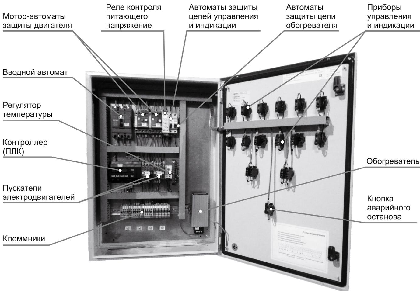
Шкафы изготавливаются напольного или настенного исполнения. Ввод кабеля в шкаф осуществляется снизу через герметичные вводы. Степень защиты шкафа IP 54.
