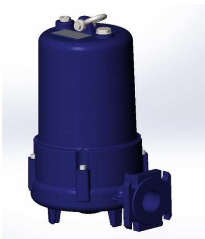
Насосы серии BIOM являются одноступенчатыми, однопоточными, несамовсасывающими, вертикальными агрегатами погружного типа с радиально расположенным напорным патрубком. Данные насосы применяются для перекачивания загрязненных вод с длинноволокнистыми примесями и твердыми частицами, при температуре до +40°C (кратковременно до +60°C, не более 3 мин) и плотностью до 1100 кг/м<sup>3</sup>.
